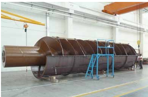
Una coclea già predisposta in officina, pronta per essere posizionata in loco
